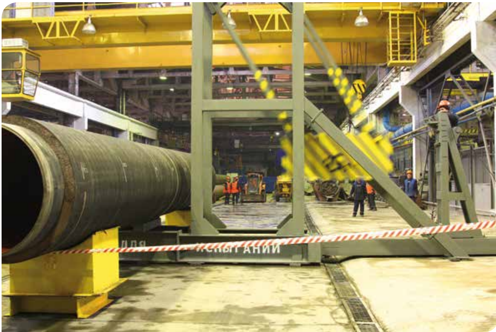
Испытания покрытия на многократный удар Coating being put to multiple blow test
