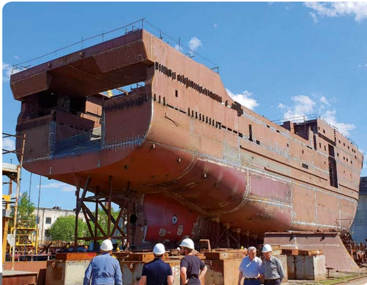
Траулер КМТ01 в процессе постройки KMT01 trawler under construction
