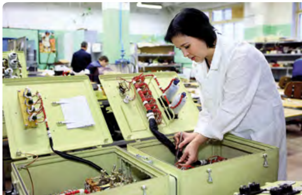
Изготовление электрораспределительных устройств в СПО «Арктика» Electrical switchgear production at SPO Arktika
